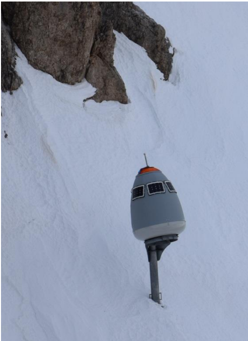
Installiertes Lawinenauslösesystem O'Bellx
